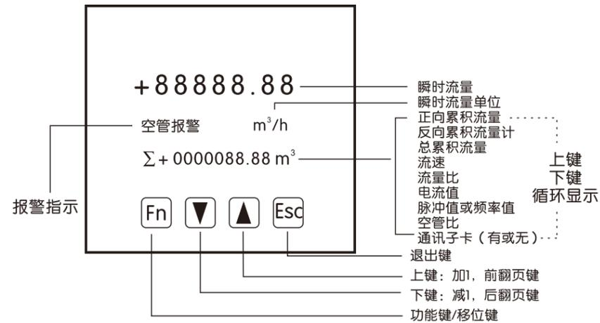
仪表上电后进入自动测量状态，实现各种测量功能并显示相应测量数据。通过操作四个面板按键，可设置和显示仪表参数。
